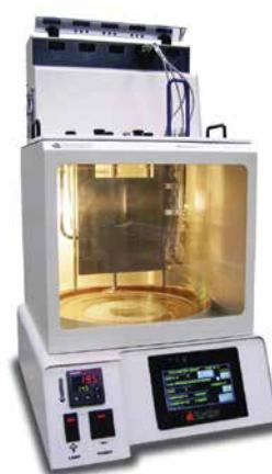
Slika 1: Uredaj za merenje viskoziteta motornog ulja
