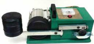
Slika 3: Uređaj za testiranje EP svojstva motornog ulja – Timken test
