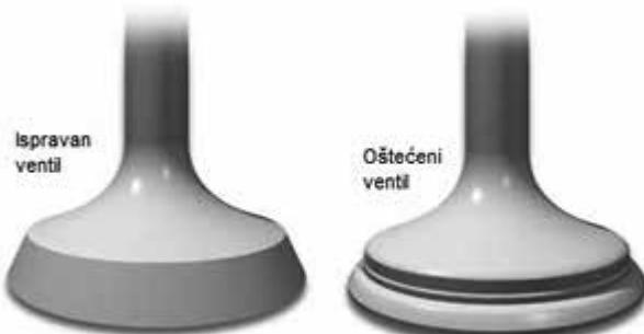
Slika 5: Izgled ispravnog i oštećenog ventila
