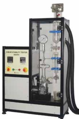
Slika 4: Uređaj za testiranje stabilnosti motornog ulja na smicanje
