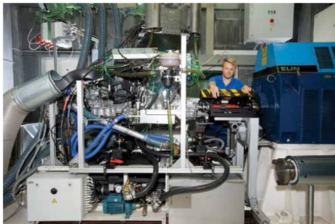
Slika 5: Ispitna instalacija SUS motora
