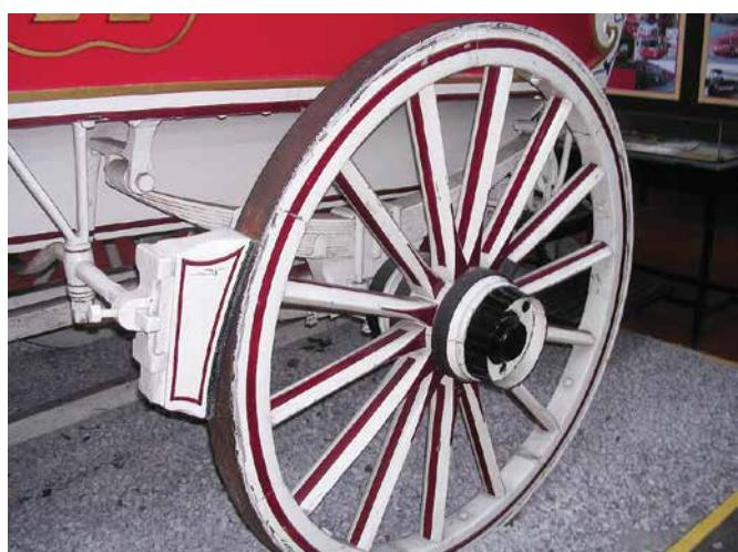
Slika 1: Kočnica na zaprežnim kolima
