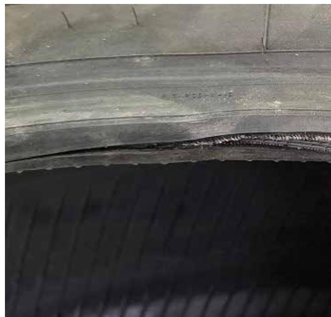
Slika 2: Oštećenje pete – falca pneumatika na mašini za montažu
