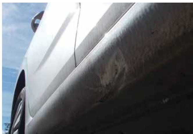
Slika 1: Oštećenje trepne od dizaličke konzole
